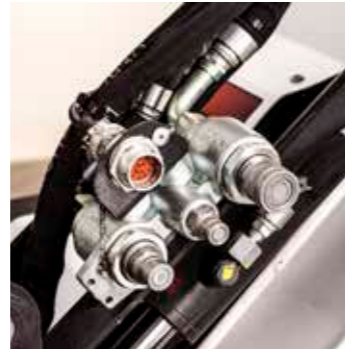
Impianto idraulico ausiliario
