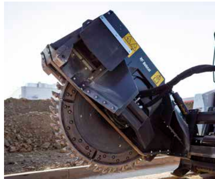
Scavacanal a disco
